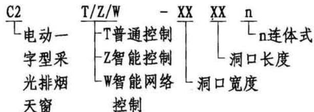
4.2 当选用连体式天窗时，可根据洞口的尺寸，在单体式选用表中选择合适尺寸的单体进行组合。
