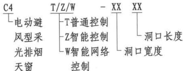
3.2 选用示例：普通控制避风型天窗，洞口宽度1000mm，洞口长度1500mm，标注为：C4T-1015。
