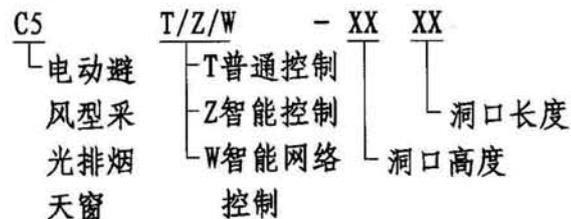
3.2 选用示例：普通控制方式侧开型电动采光排烟天窗，洞口高度1200mm，洞口长度6000mm，标注为：C5T-12600。
