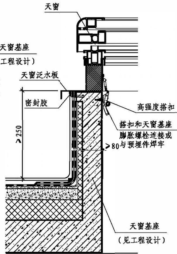
钢筋混凝土屋面洞口安装构造
